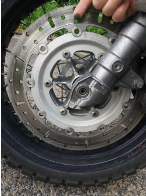
Kuva 1. Harmaan kalvon peittämä liukaspintainen etujarrulevy 23.6.2021.
