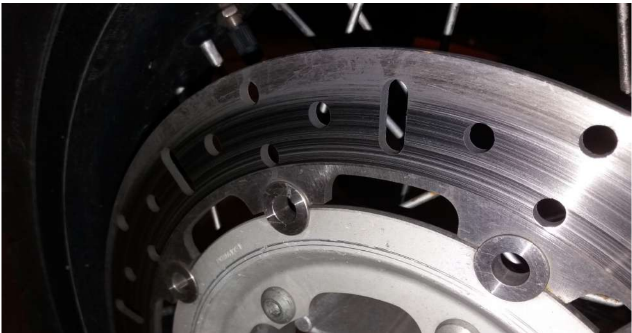
Kuva 2. Harmaan kalvon peittämä liukaspintainen etujarrulevy 12.10.2021.
