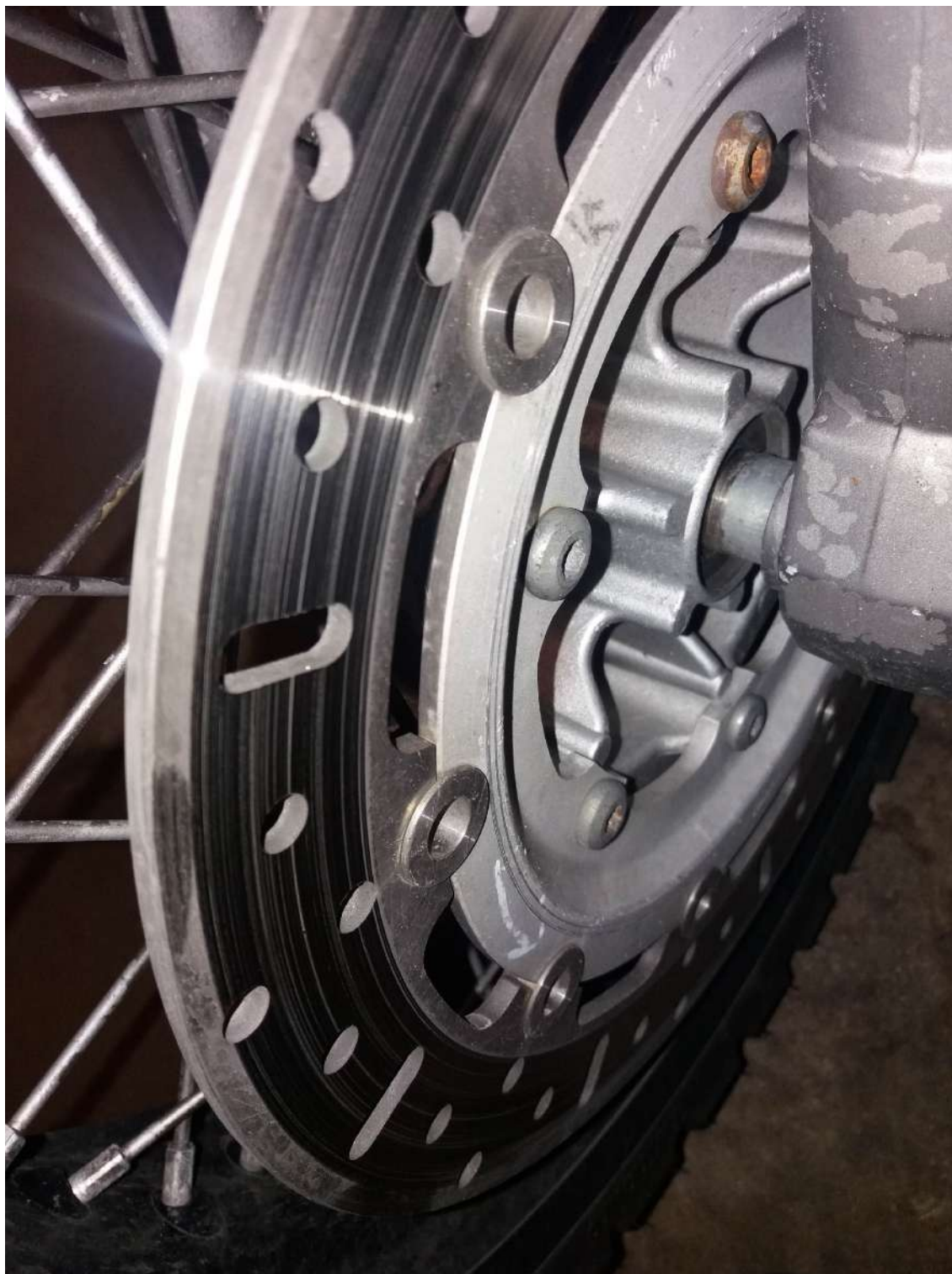
Kuva 2. Tummanharmaan kalvon peittämä etujarrulevy 16.10.2021.
