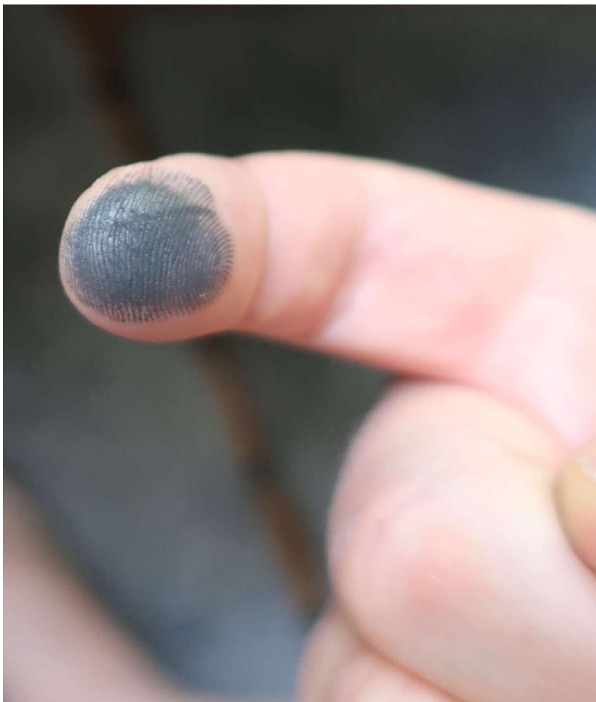
Kuva 2. Etujarrulevystä irtoavaa harmaata liukasta ainetta 13.8.2021.
