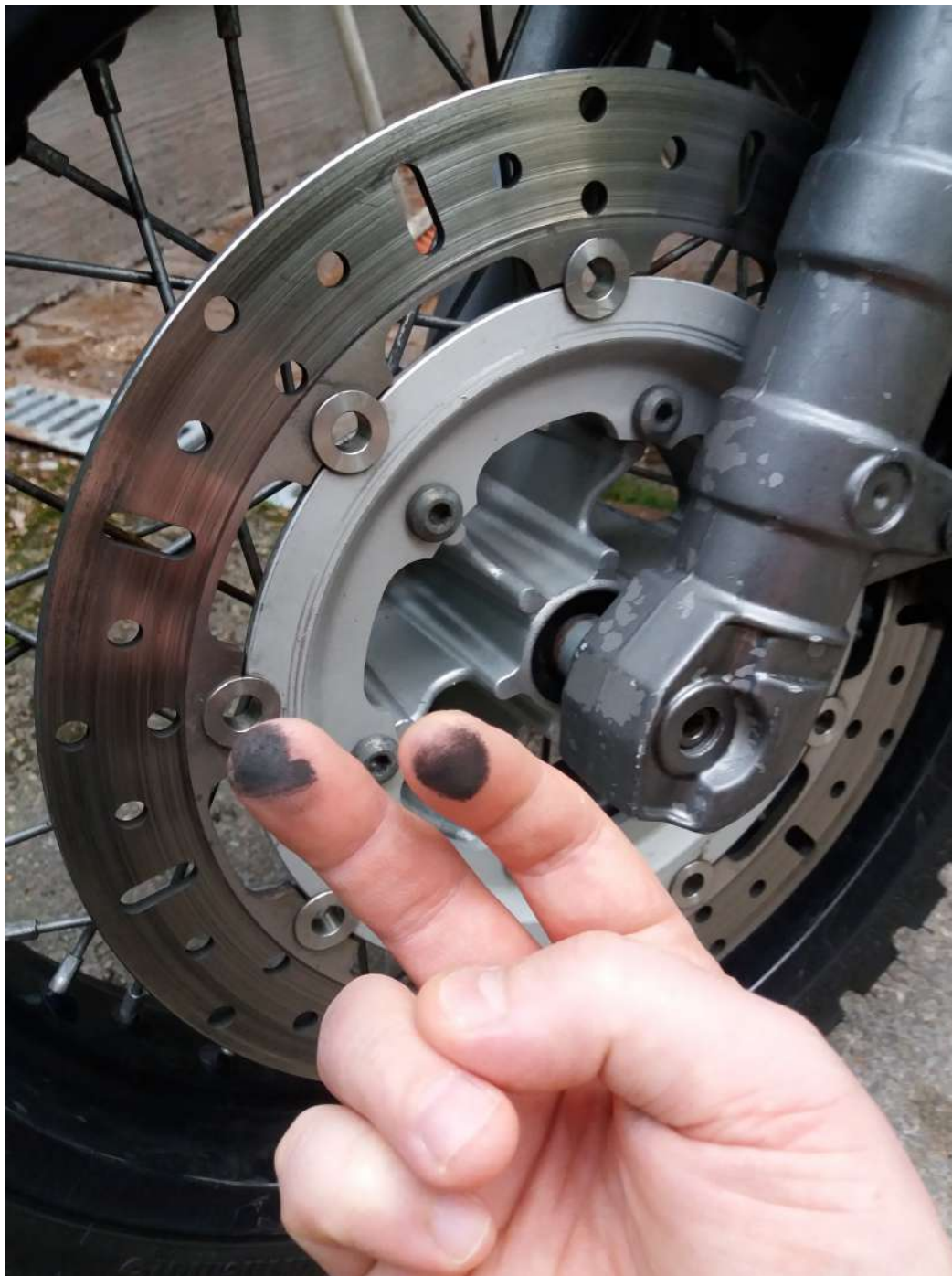
Kuva 1. Harmaan kalvon peittämä liukaspintainen etujarrulevy 11.8.2021.
