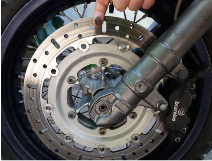
Kuva 1. Harmaan kalvon peittämä liukaspintainen etujarrulevy 29.6.2021.
