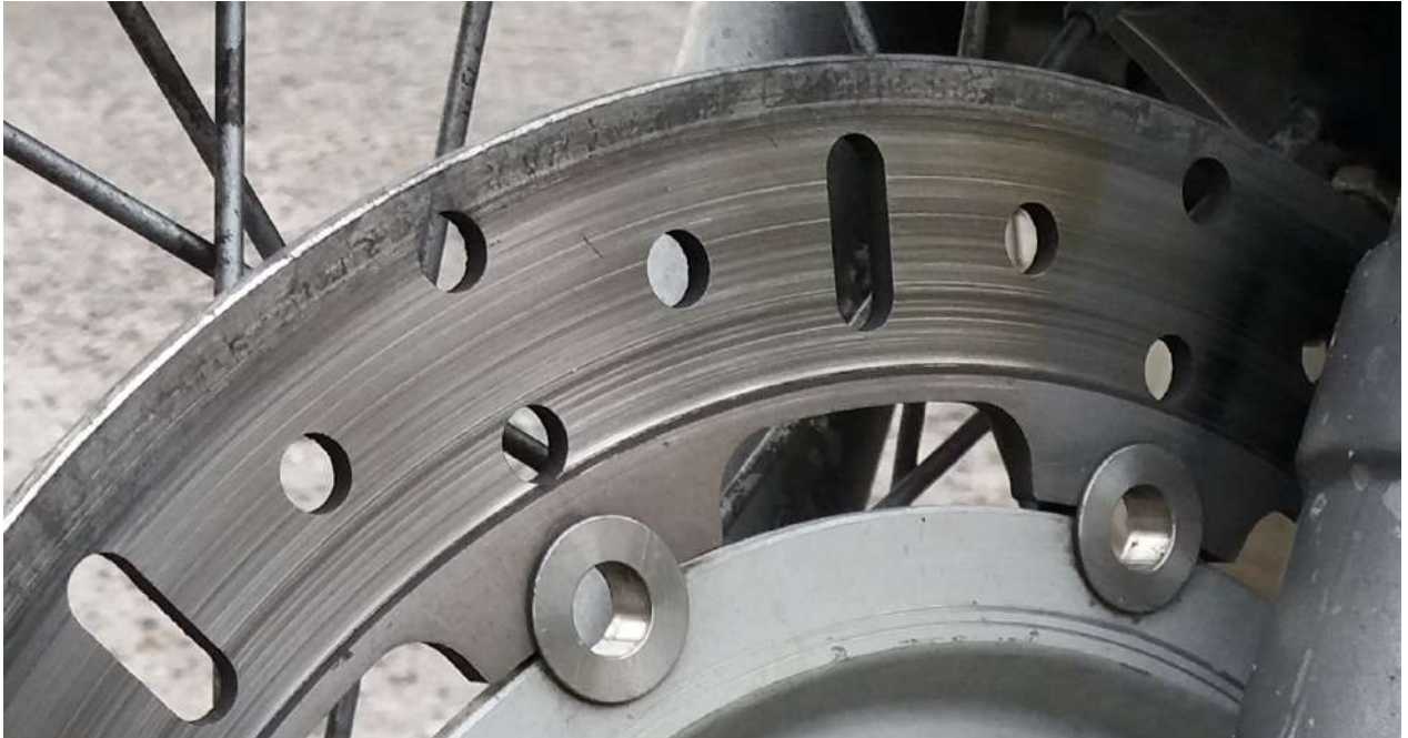
Kuva 1. Tummanharmaan kalvon peittämä etujarrulevy 11.10.2021.
