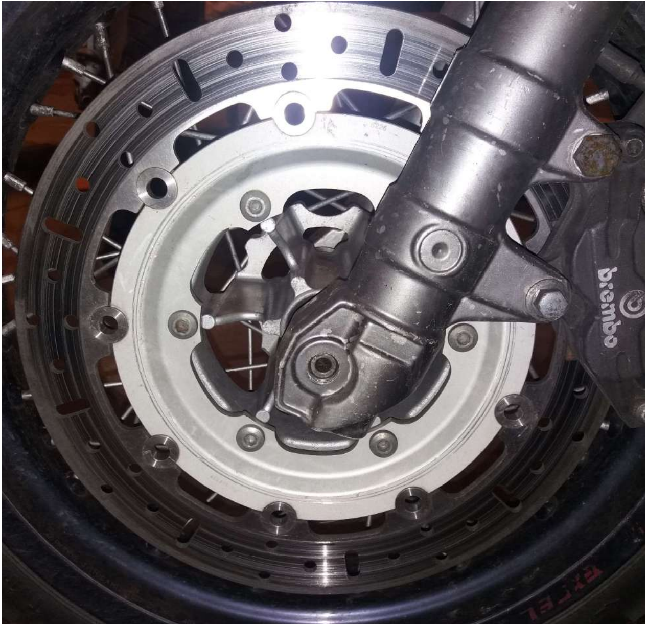
Kuva 3. Harmaan kalvon peittämä liukaspintainen etujarrulevy 16.10.2021.
