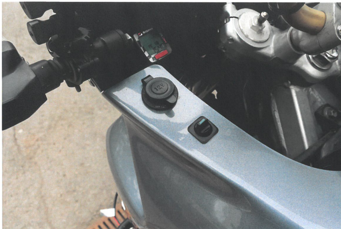
Kuva 5. Virranulosotto, Offroad valokytkin, ajotietokone, Garmin kamerateline.
